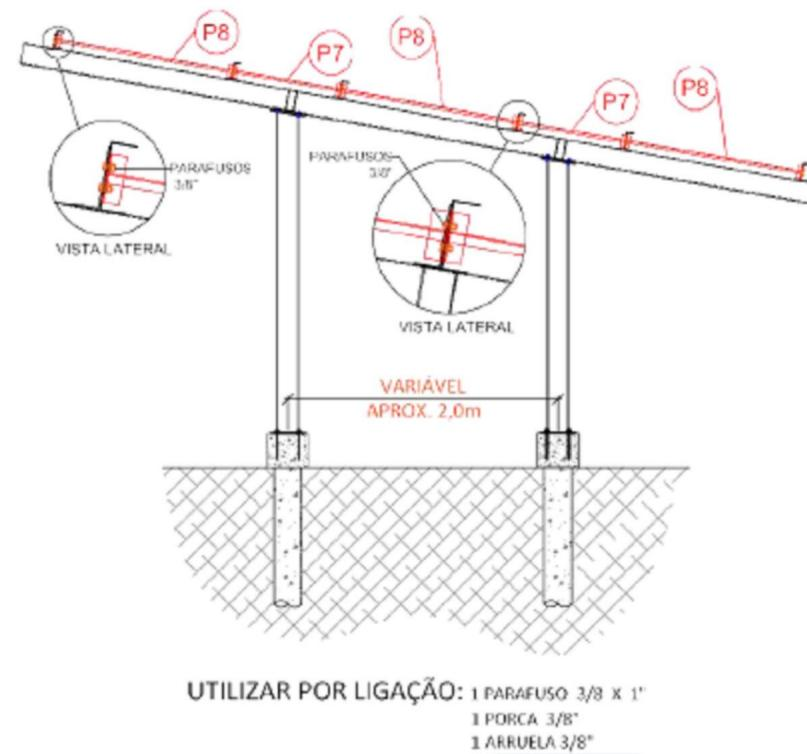
DETALHE DA FIXAÇÃO DAS CORRENTES RÍGIDAS NAS TERÇAS
