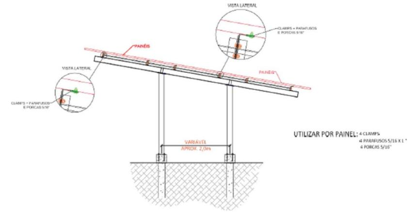
DETALHE DA FIXAÇÃO DOS PAINÉIS NAS TERÇAS
