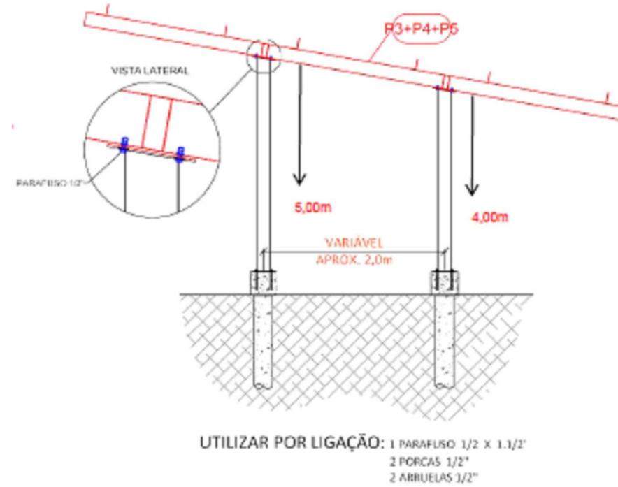
DETALHE DA FIXAÇÃO DAS LONGARINAS NOS PILARES
