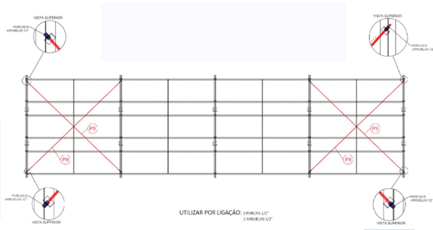
DETALHE DA FIXAÇÃO DAS BARRAS DE CONTRAVENTAMENTO
